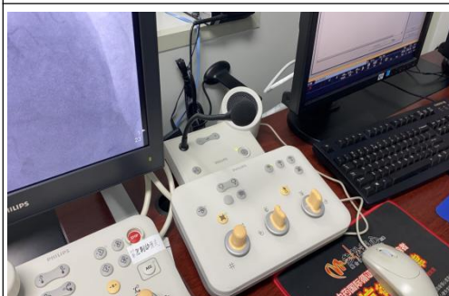
操作台紧急停机按钮及对讲系统 (DSA1 机房)
